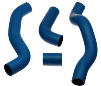
**Комплекты патрубков (синий цвет)** предназначены для циркуляции охлаждающей жидкости в системе охлаждения двигателя автомобиля.
