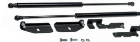
**Амортизаторы капота** позволяют комфортно открывать и закрывать капот, сохраняя чистыми одежду и руки.
