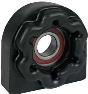
**Опора карданного вала** служит для компенсации центробежной силы и весовых нагрузок при большой длине сопряжения. Она не позволяет карданному валу провисать под собственным весом и отклоняться от оси при вращении.
