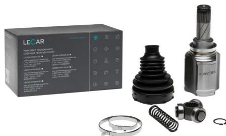
**Шарниры равных угловых скоростей (ШРУС)** обеспечивают передачу крутящего момента с приводных валов КПП к колесам на угол до 70 градусов. Поставляются в готовом к монтажу комплекте.
