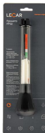
**Ареометры** предназначены для измерения плотности электролита и оценки технического состояния АКБ.
